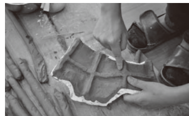
⑤歪みや割れを防ぐためにリブ (補強の土手) 付け
