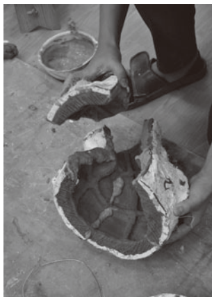
(上中央) ⑧合わせの完成 ゴムひもや針金などで圧力をかけてしっかり合わせる
