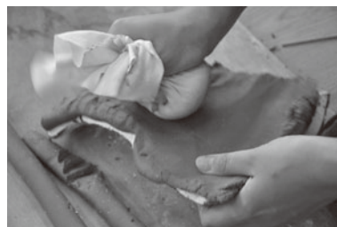
③タンポで土シワを伸ばし空気を押し出す
