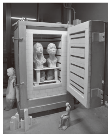
⑩電気窯入れ 作品の大きさ、厚みによって焼成時間はまちまちですが100から500度まで、 ゆっくりと温度を10時間かけて上げ、 800度までは3時間かけ焼成
