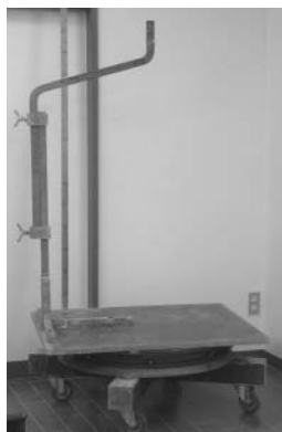
回転台に粘土板をつけ、アングルを設置したもの
